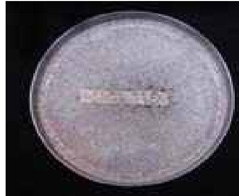
fara tratament fungistatic =depuneri evidente
